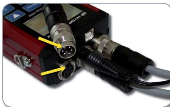
Abb. 2 Sensoren anschließen
