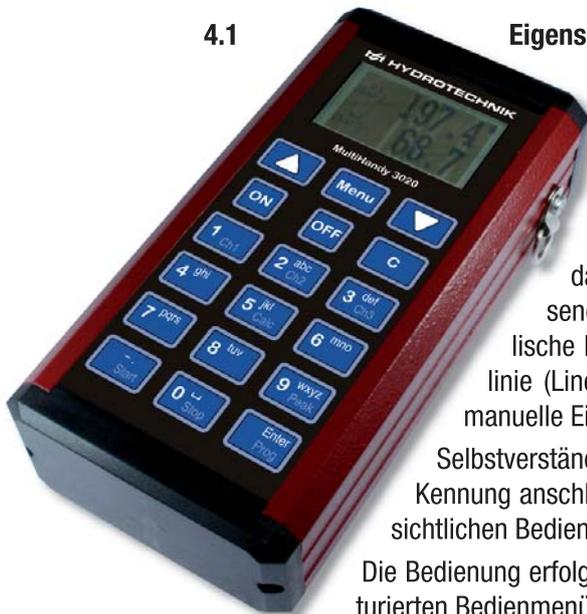
Das MultiHandy 3020 ist ein hochwertiges 3-Kanal Messgerät, das dem Anwender alle Funktionen zur Verfügung stellt, die er für die Bewältigung anspruchsvoller Aufgaben im Bereich professioneller Messtechnik erwartet und benötigt.
