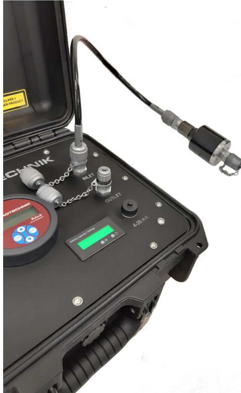
Abbildung 7: Anschluss an Druckleitung über das Druckbegrenzungsventil
